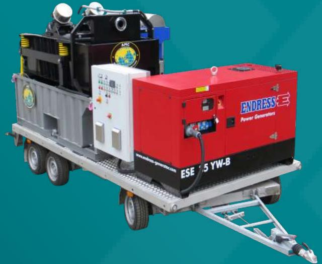
Mobile Separationsanlage für HDD Bohrungen, Geothermal Bohrungen und Brunnenbauprojekte.
