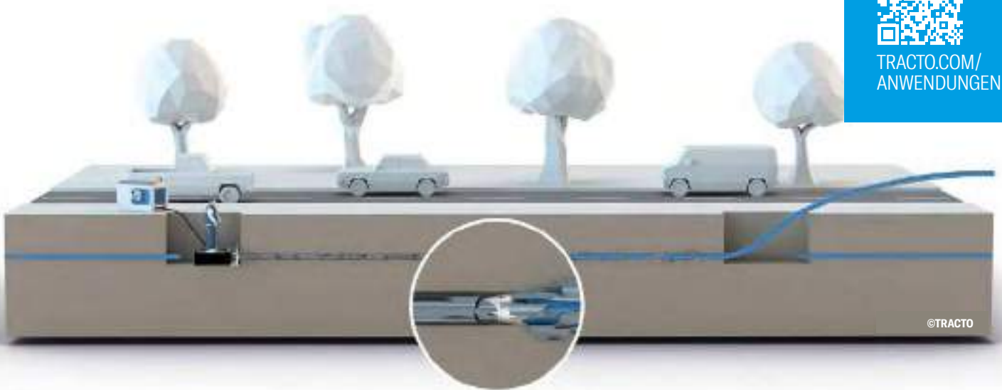
Anwendungsbeispiel Erneuerung einer Wasserleitung
