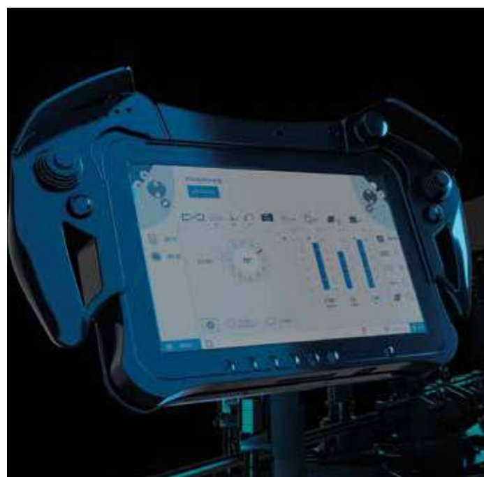
Innovative, herausnehmbare Fernbedienung ermöglicht ferngesteuertes Bohren
