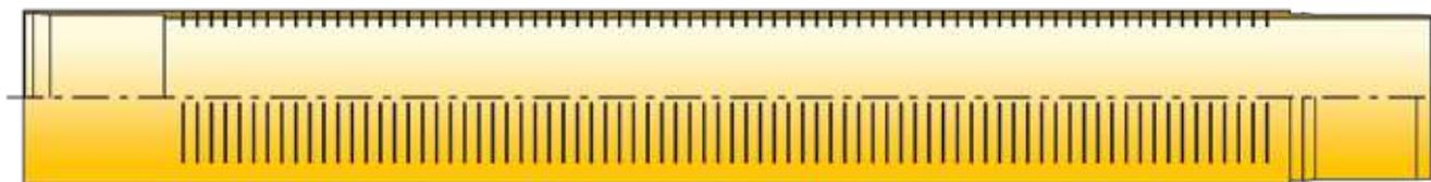
Die bereits werkseitig vorgenommene **Schlitzung** dient zur Ortung von Schadstellen an Gasrohren. Im Falle einer Havarie wird das ausströmende Gas abgeleitet und ein Austritt im Hausanschluss sicher verhindert.
