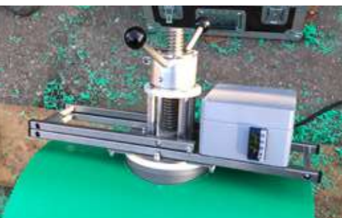
Werkzeugset für Einschweißstützen
